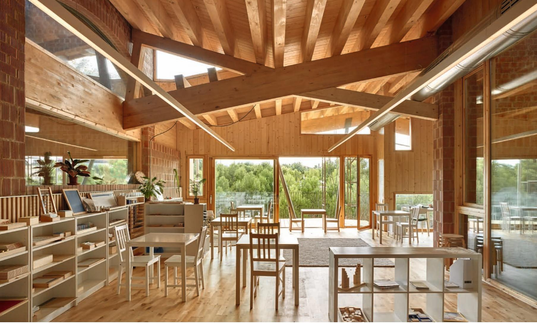
Se usan masivamente los materiales de menor huella ecológica: barro cocido y madera. El muro de ladrillo es estructura, partición y revestimiento; el hormigón sólo se usa en cimentación y el acero en pilares singulares y barandillas.
